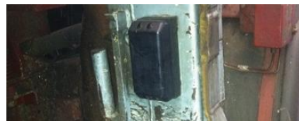
Antena RFID de baja Frecuencia, situada en el brazo del camión, de carga lateral
