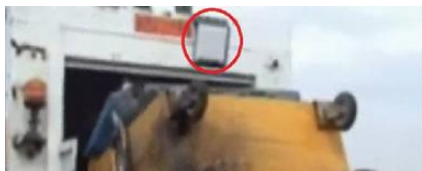
Antena RFID de Alta Frecuencia, situada en un camión de carga trasera
